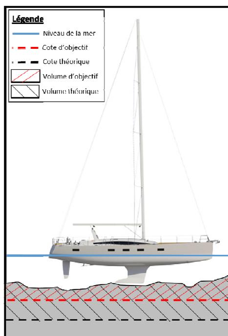
Figure 9 : Différence entre cote de dragage d'objectif et cote de dragage théorique
