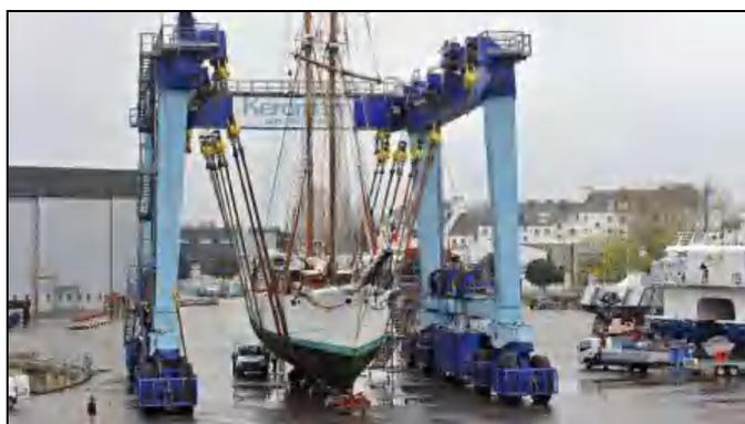
*Photo 4 : Vue du voilier L'Etoile manutentionné par l'élévateur à bateaux de Keroman (Ouest France, Thierry Creux©)*
