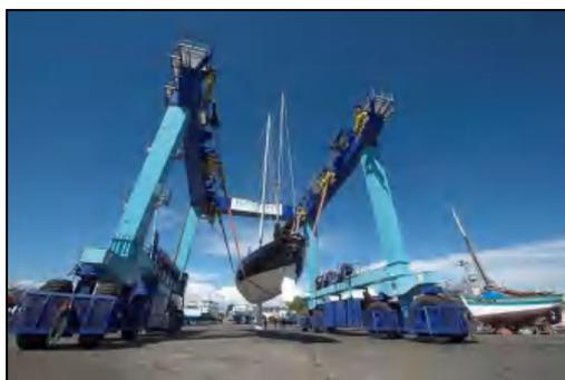
*Photo 13 : Vue de l'élévateur à bateaux 650 tonnes de Keroman ([www.keroman.fr](http://www.keroman.fr))*
