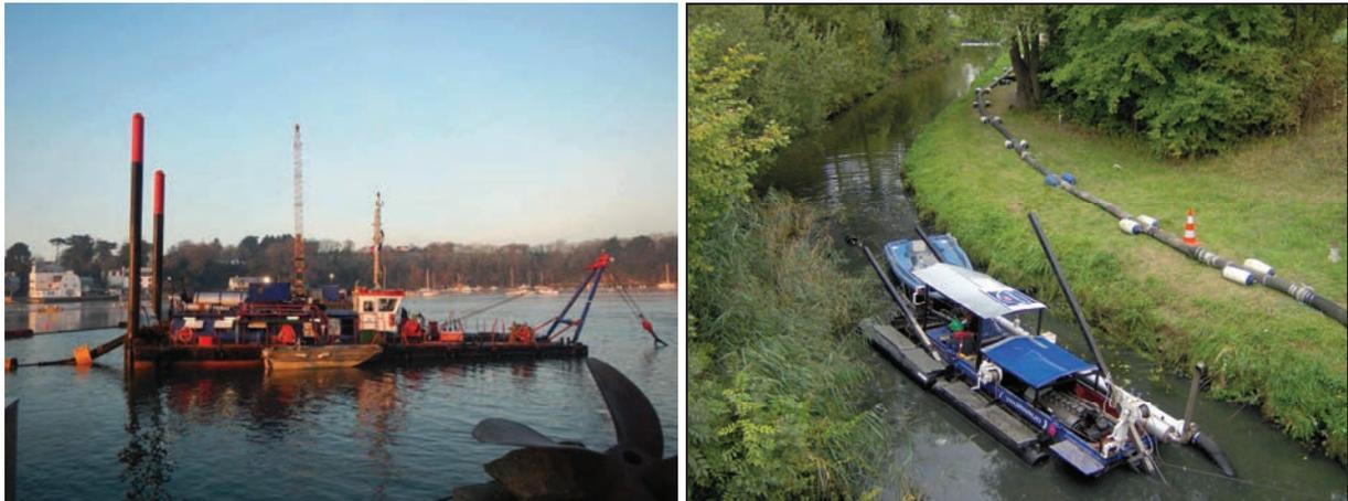
Photo 3 : Exemples de dragues hydrauliques stationnaires (à gauche : stabilisée par des pieux (Guidel, 2015) ; à droite : stabilisée par des câbles) [Lorient Agglomération ; In Vivo]
