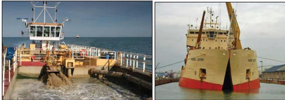
*Photo 8 : Vue du puits d'une drague aspiratrice en marche : à gauche : en cours de remplissage ; à droite : pendant l'ouverture*
