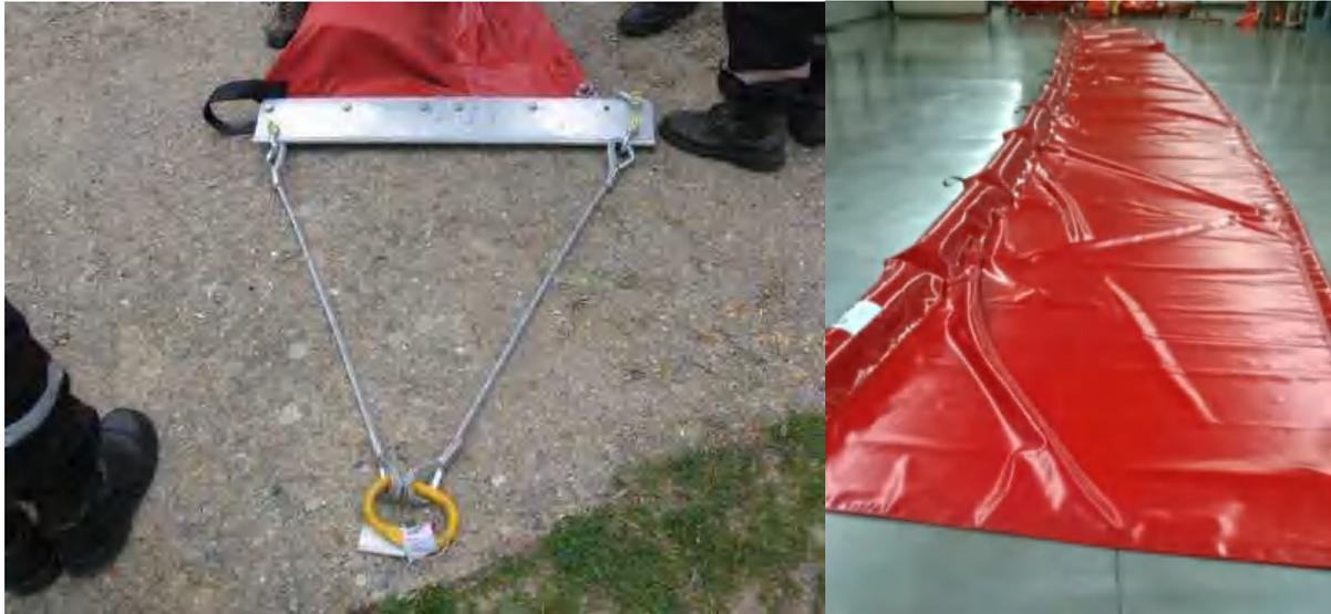
Figure 18 : Vue du boulonnage du flotteur et vue d'ensemble du rideau avec sa jupe (source Difope)
