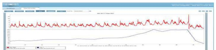
Cassure sur la conduite principale de la zone Fétan Berr, DN140 mm, avec une évolution des débits de nuit passant de 0,6 m<sup>3</sup>/h à 4,5 m<sup>3</sup>/h en un mois. Sa détection a mobilisé des recherches de jour et de nuit, aux moyens d'écoutes et d'équipements de corrélation acoustique. La fuite n'était pas visible car coulait à débit constant dans la conduite d'eaux pluviales attenante.
