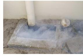
humains et les animaux, ne tache pas et se dissipe en peu de temps. Toutefois, en cas de mauvaise configuration du système d'évacuation, de la fumée est susceptible de pénétrer dans les habitations pouvant déclencher certaines alarmes incendie. Une simple aération de la pièce suffit à la dissiper.
